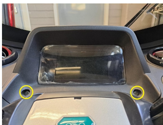
Irrota mittariston kiinnitysruuvit. (ristipäämeisseli ph2).
